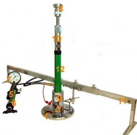
Rys. 1.2 Aparatura VSS z jednopunktowym pomiarem przemieszczenia płyty
