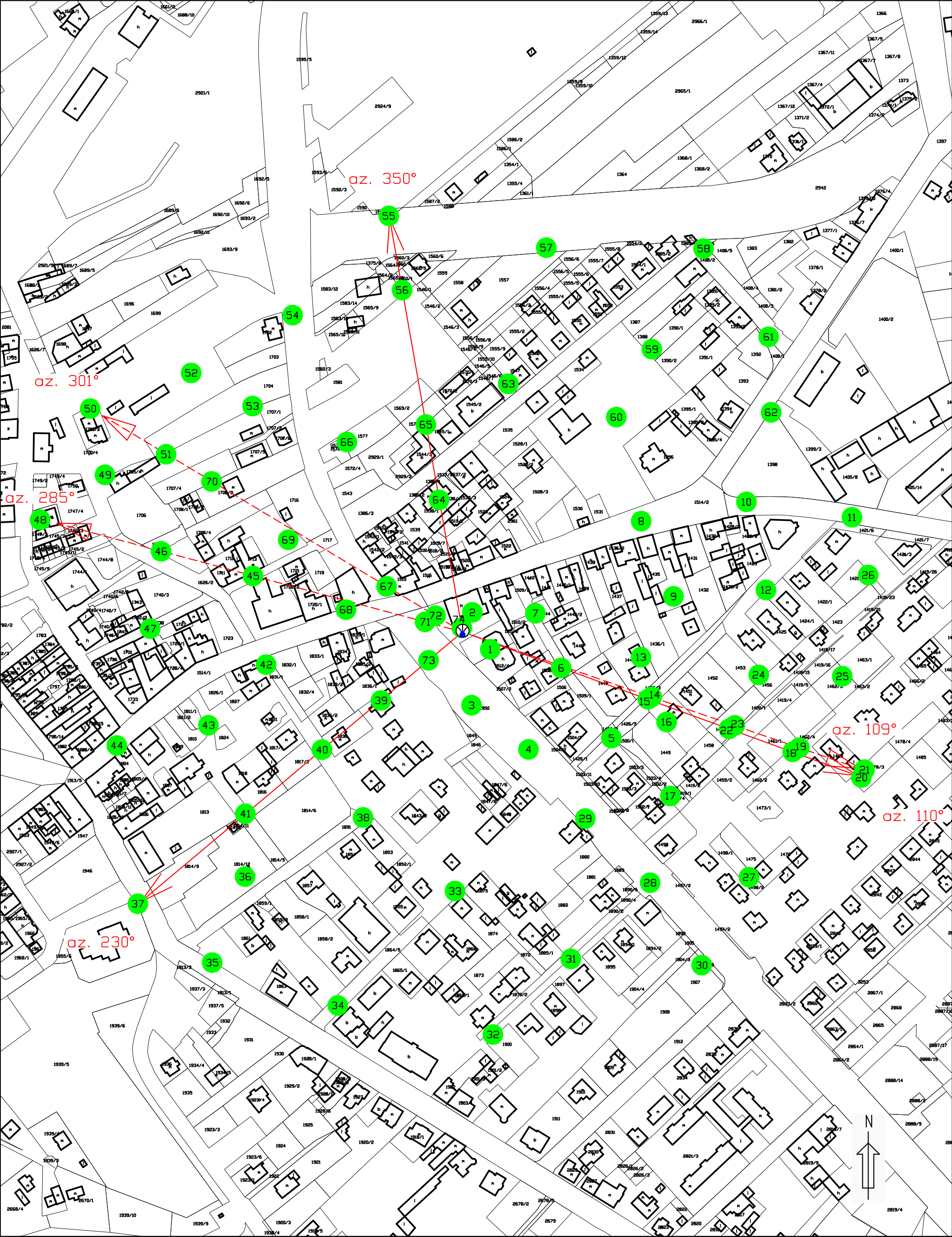
Rys.1 Lokalizacja pionów pomiarowych
